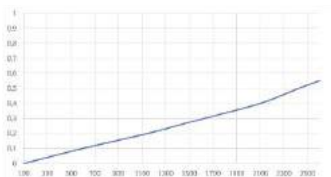
Portata a 6 bar ΔP 1 bar - Flow rate at 6 bar ΔP 1 bar - Durchfluss bei 6 bar ΔP 1 bar - Débit à 6 bars ΔP 1 bar - Caudal a 6 bar ΔP 1 bar
